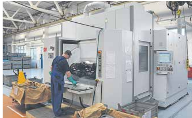
Nové dvouvřetené pětiosé obráběcí centrum SW BA622 již pracuje v divizi Obrábění MOTORU JIKOV Strojírenská a.s.
